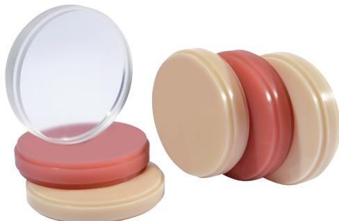
Discos de PMMA para el mecanizado CAD-CAM de puentes y coronas provisionales, realizados con resina de alto peso molecular cross-linked, que garantiza fidelidad en la reproducción de los detalles y resistencia incluso con espesores sutiles.
